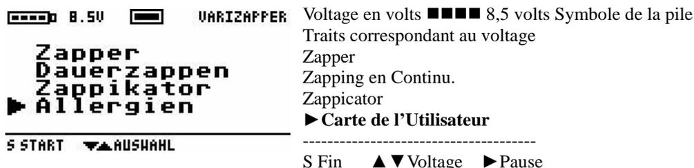
Une fois que le voltage de la pile est descendu à 5.7 V et qu'il n'y a plus de traits visibles, il reste habituellement suffisamment d'énergie pour finir le programme en cours. Remplacer la pile une fois le programme terminé, comme indiqué dans la section 6.2.
